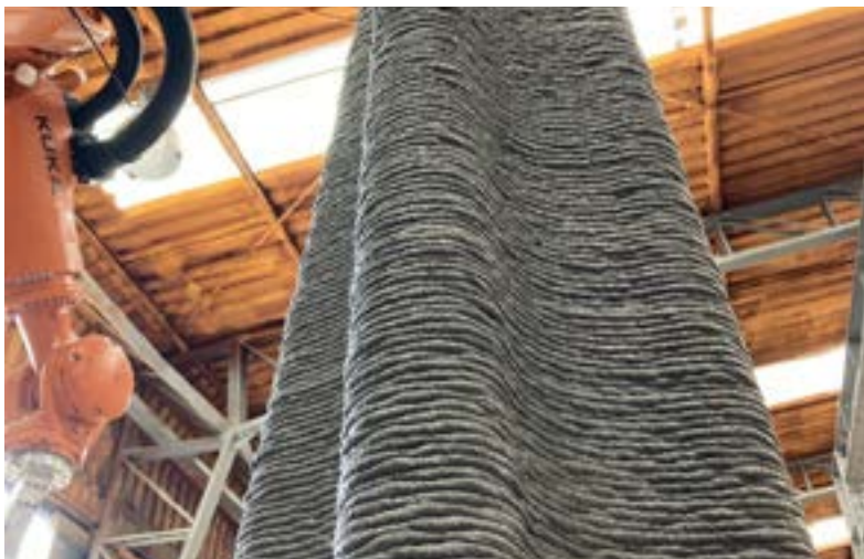
Columna impresa en hormigón 3D del proyecto FONDART: "Anaquel de Manufactura Aditiva: Hacia un Nuevo Lenguaje Arquitectónico" elaborada en el laboratorio CITEC UBB.
