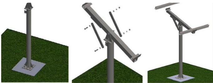
Imagen N°2: Sistema de Anclaje Monopostes. Fuente: Wanhos, 2023.
