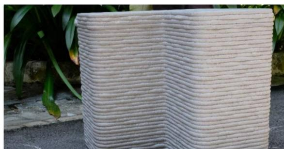
Imagen N°2: Banca de hormigón impreso 3D utilizada como piloto de la investigación de mezcla de vidrio reciclado. Fuente: NTU Singapore, 2021.
