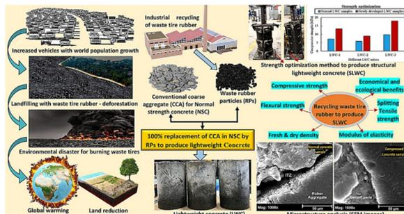
Imagen N°3: Sustitución de agregados por particular de caucho; Fuente: Revista Recursos, conservación y reciclaje,Volumen 184, 2022.
