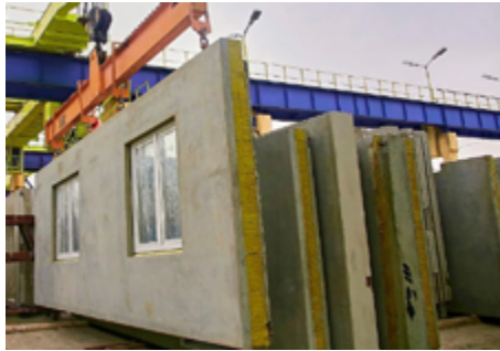
Imagen N°3: Equipo de montaje lateral para almacenamiento de elementos prefabricados. Fuente:Reto Kommerling (2023).
