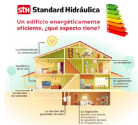
Imagen N°2: Diseño considerando eficiencia energética. Fuente: *STH (2018)*.
