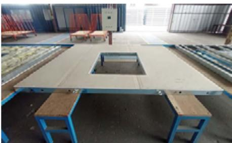
Imagen N°2: Fabricación fachada industrializada. Fuente: CINTAC (2024).
