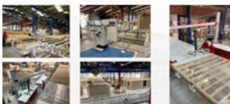
Imagen N°1: Construcción módulos fábrica industrializada: Tecno Fast (2024).
