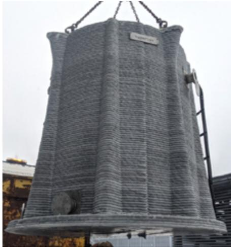
Imagen N°1: Tanque de Agua impreso en 3D - Hormigón. Fuente: hyperionrobotics,2024.
