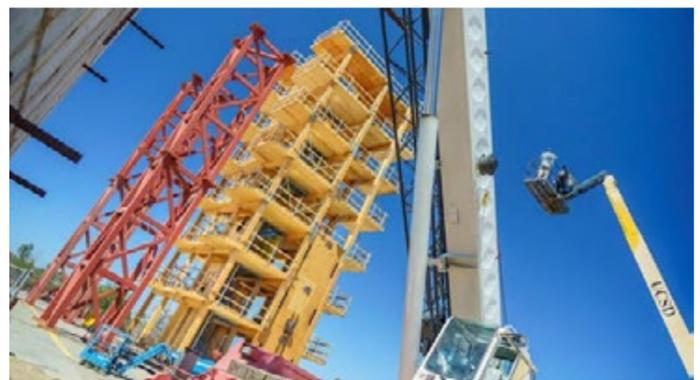
Imagen N°2: Mass Timber: Primera simulación de terremoto en un edificio en madera de 10 pisos (*ArchDaily, 2023*).
