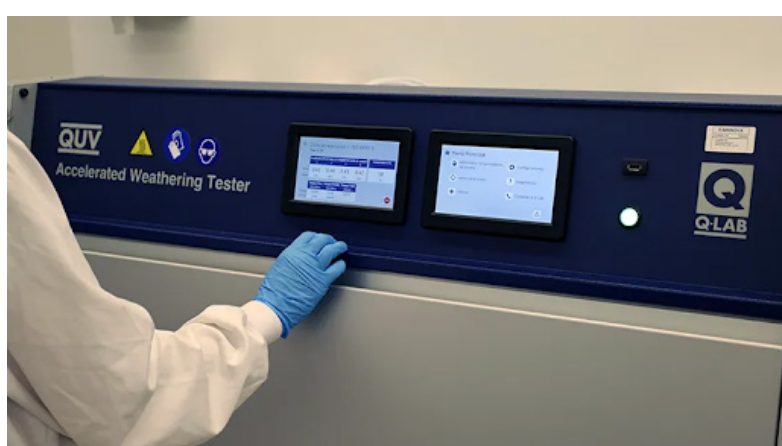
Imagen N° 4: Ensayos de envejecimiento con luz. Fuente: ITA, 2025.
