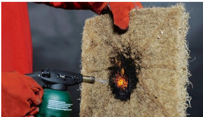
Imagen 1: Aislante con raíces de cereales, resistente al fuego desarrollado por Rootman. (País circular.cl, 2023)
