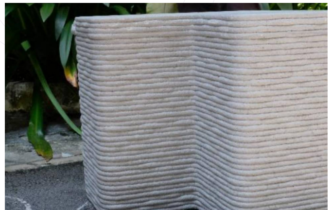
Imagen N°2: Banca de hormigón impreso 3D utilizada como piloto de la investigación de mezcla de vidrio reciclado. Fuente: NTU Singapur, 2021.
