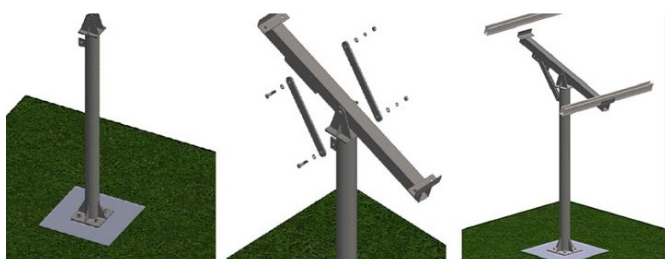
Imagen N°2: Sistema de Anclaje Monopostes. Fuente: Wanhos,2023.
